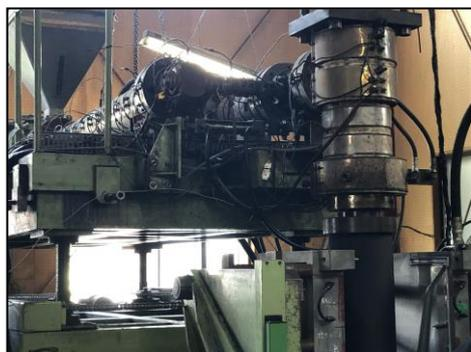
【溶かされたプラスチックを部品の形にプレスし、その後人の手で成形していきます】
